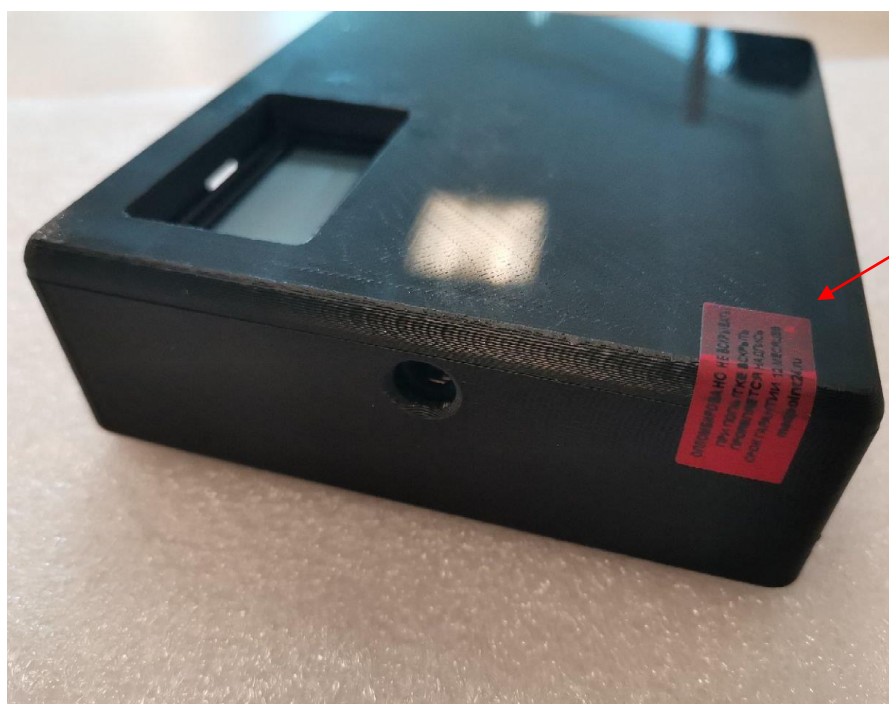
Рисунок 2 – Схема пломбировки от несанкционированного доступа
