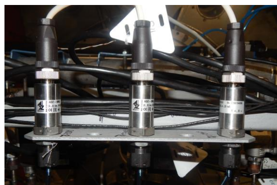
Рисунок 4 – Датчики давления, разрежения и разности давлений ADZ
