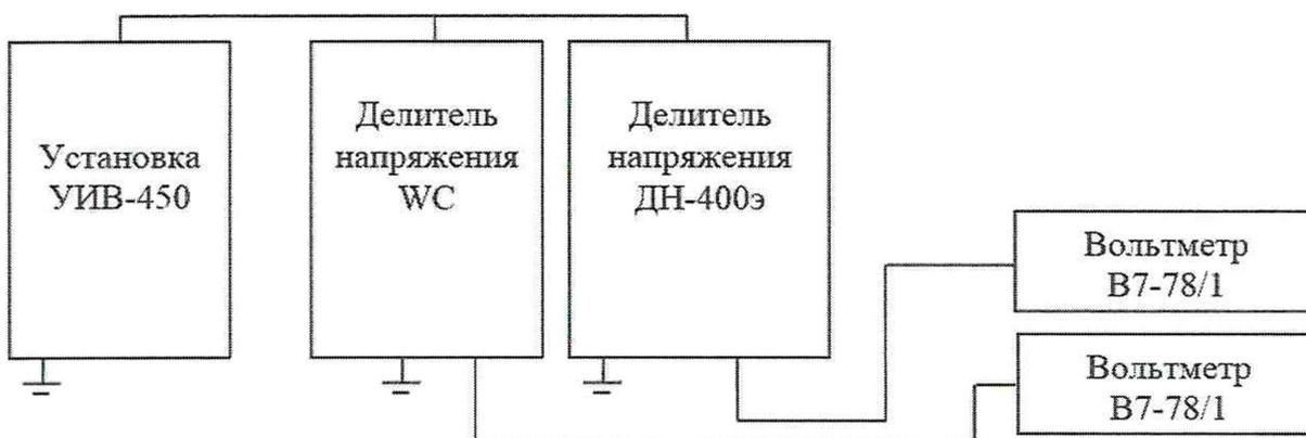
Рисунок 3 - Схема измерений напряжения переменного тока до 400 кВ
