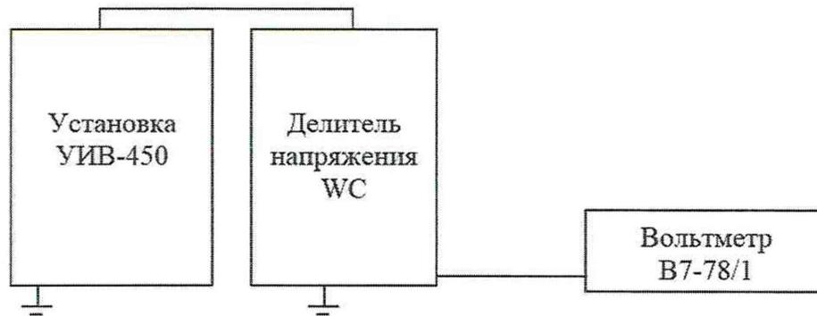
Рисунок 1 - Схема измерений напряжения переменного тока
