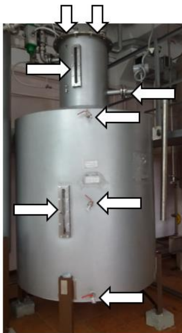
Рисунок 2 – Схема пломбировки мерника МТ-ВИЦ-250Н-1, зав.№ 21-25/07-02 от несанкционированного доступа, обозначение места нанесения знака поверки.
