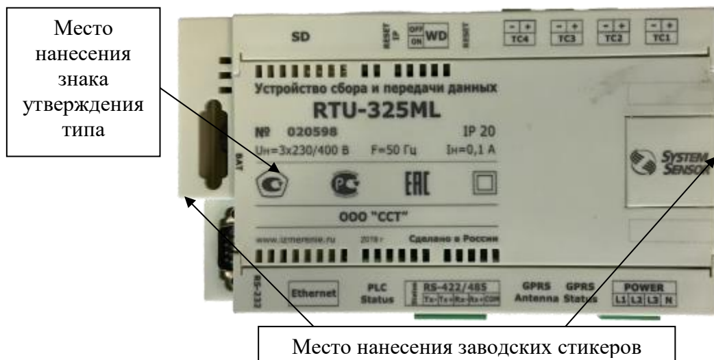
Рисунок 1 – Общий вид УСПД с указанием места нанесения знака утверждения типа и нанесения заводских стикеров
