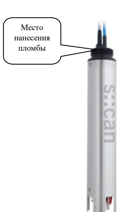
Рисунок 7 – общий вид первичного преобразователя ammo lyser и схема пломбировки от несанкционированного доступа
