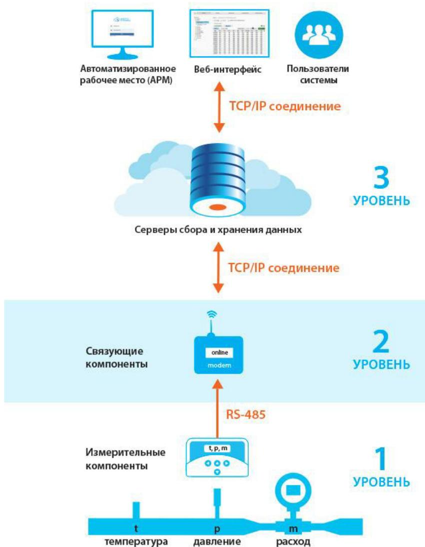
Рисунок 1 - Структурная схема ИИС «Энерготроника»
