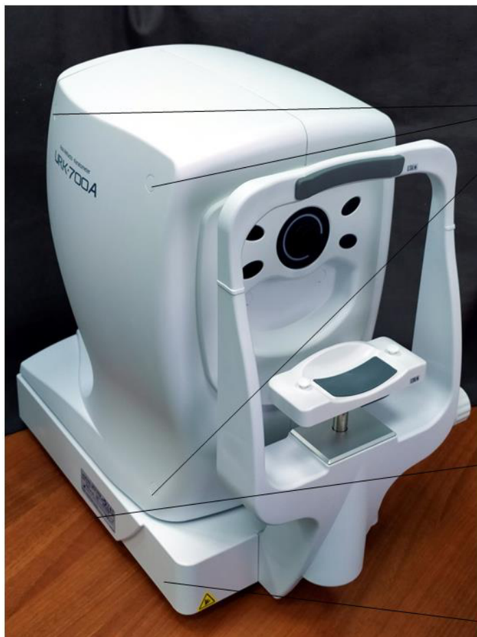
Рисунок 2 – Общий вид, схема маркировки и схема пломбирования от несанкционированного доступа авторефрактометра URK-700A
