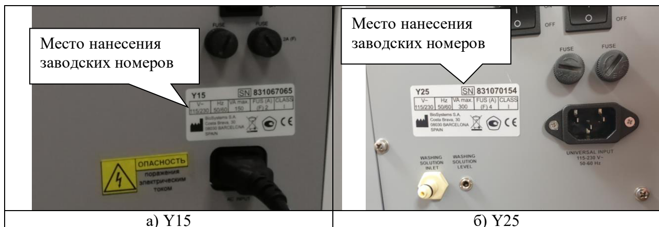
Рисунок 3 – Места, способы и формат нанесения заводских номеров или буквенно-цифровых обозначений, однозначно идентифицирующих каждый экземпляр средств измерений.
