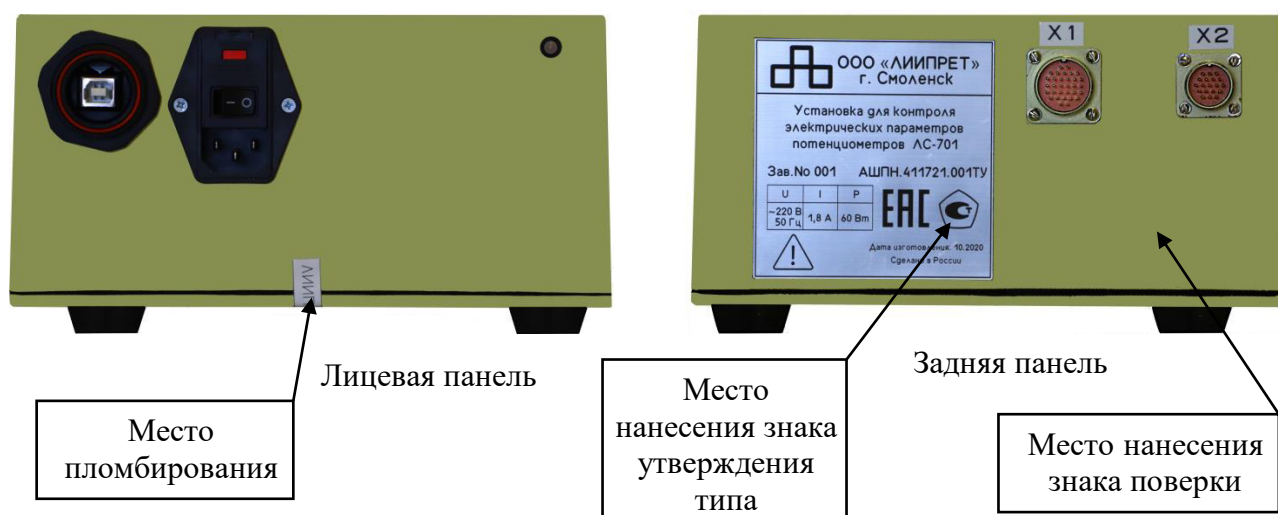
Рисунок 2 – Общий вид приборного блока, обозначение места нанесения знака поверки, знака утверждения типа и схема пломбировки
