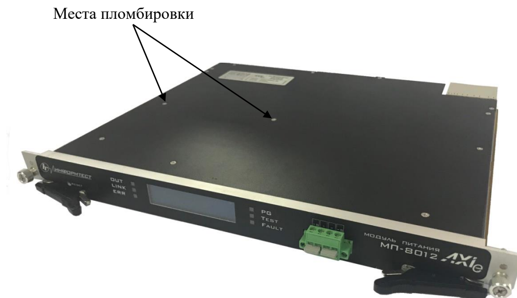
Рисунок 2 – Общий вид модулей питания МП-8012 AXIe-0 в черном корпусе с указанием мест пломбирования
