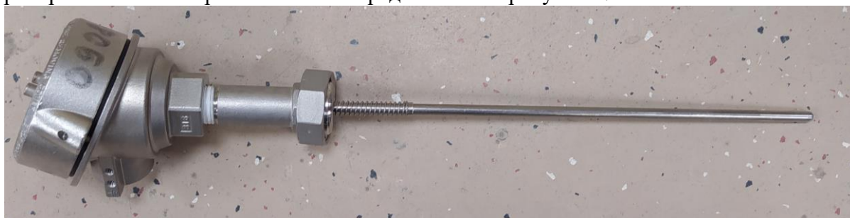
Рисунок 1 – Общий вид первичного преобразователя ПТ
