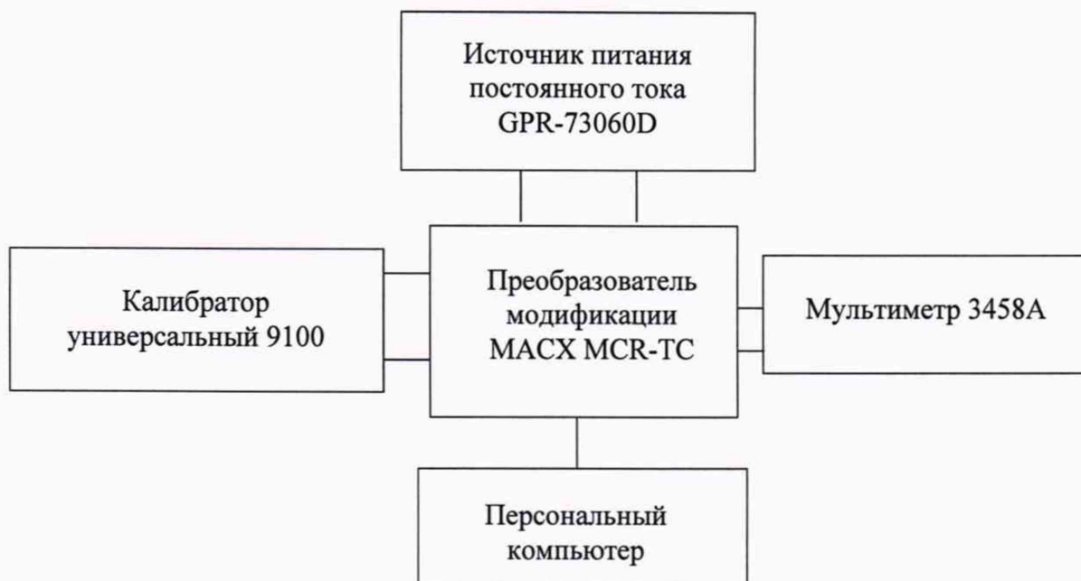
Рисунок 2 – Схема подключений для поверки преобразователя модификации MACX MCR-TC
