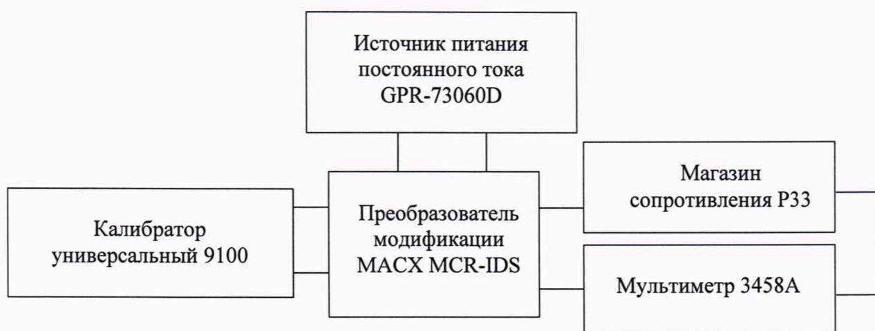
Рисунок 1 – Схема подключений для поверки преобразователя модификации MACX MCR-IDS
