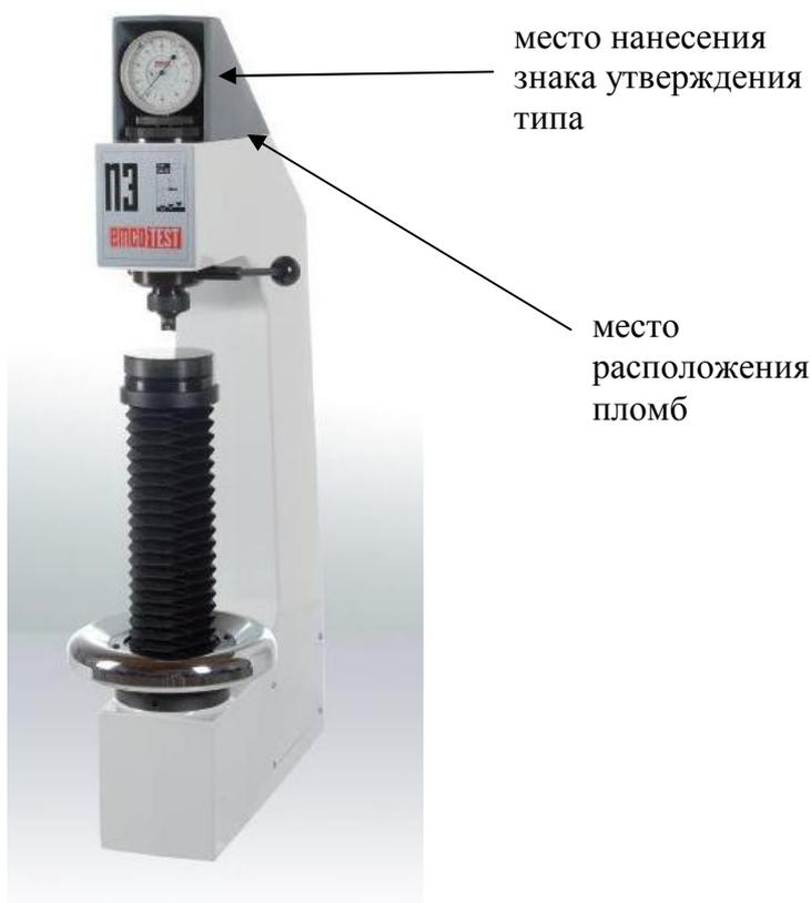
Рисунок 1 – Внешний вид твердомеров
