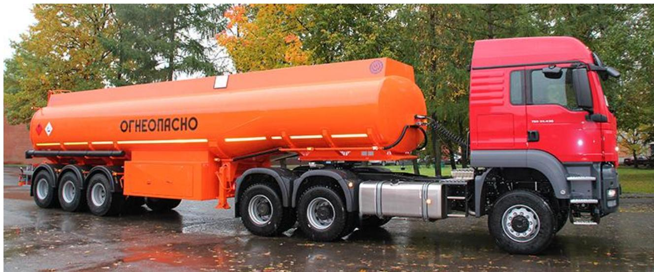
Общий вид полуприцепов-цистерн БЦМ-176 модель 96057
