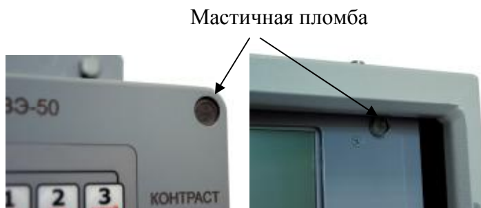
Рисунок 4 – Схема пломбировки прибора
