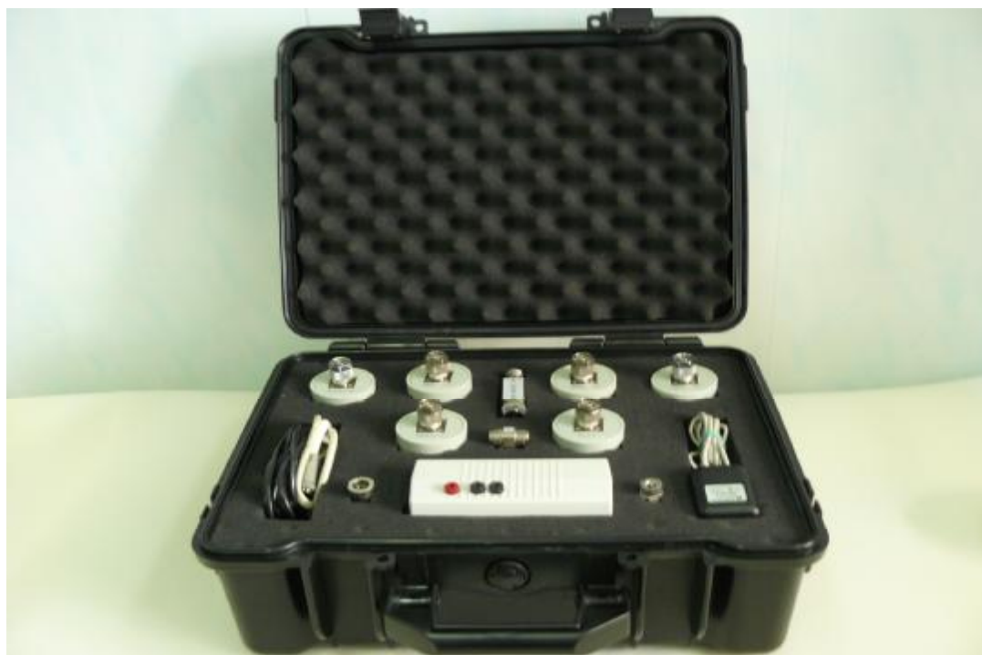
Рисунок 1 Внешний вид модулей одиночных преобразователей (6 шт.) ПНТЭ-36-0,003 (П1); ПНТЭ-36-0,01(П2); ПНТЭ-36-0,03 (П3); ПНТЭ-36-0,1 (П4); ПНТЭ-36-0,3 (П5); ПНТЭ-36-1(П6).
