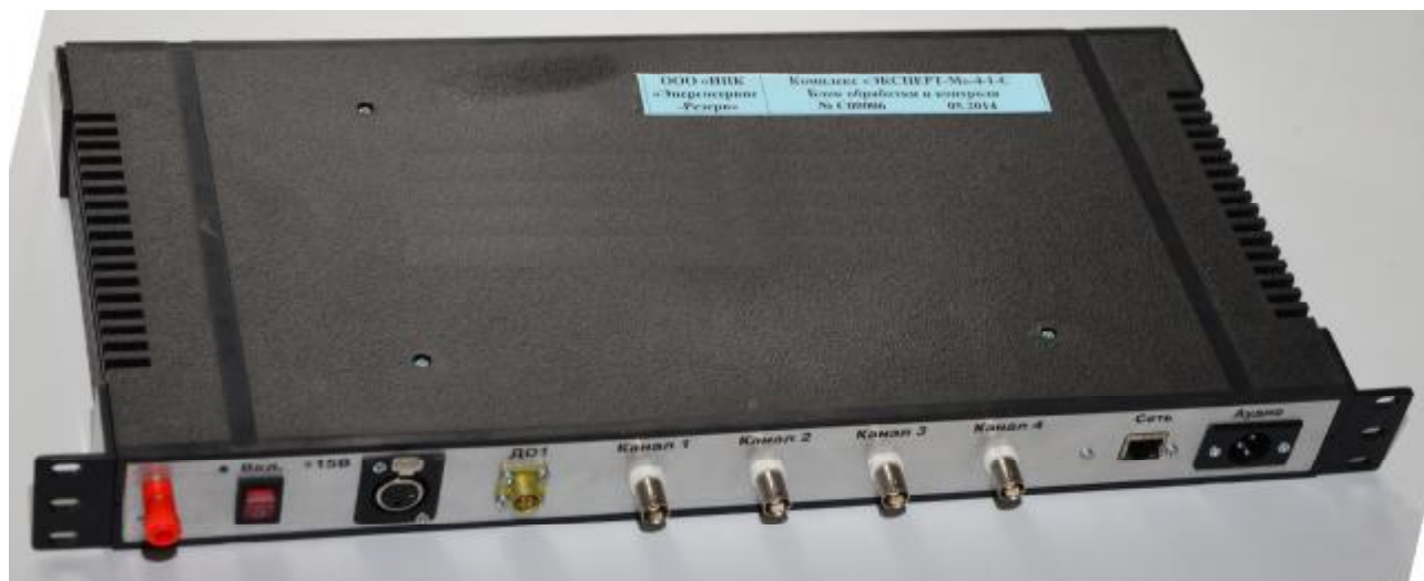
Рисунок 2- Внешний вид комплекса оперативного контроля (вибрoанализатора) «Эксперт-М»-4-1-С, стационарный вариант исполнения
