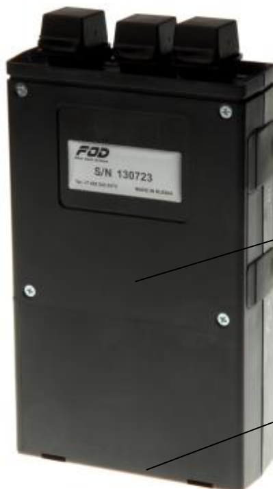
Рисунок 2 – Место пломбирования от несанкционированного доступа
