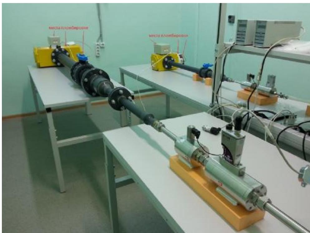
Рисунок 1 - Общий вид установки поверочной СПИ-03 с указанием мест пломбировки
