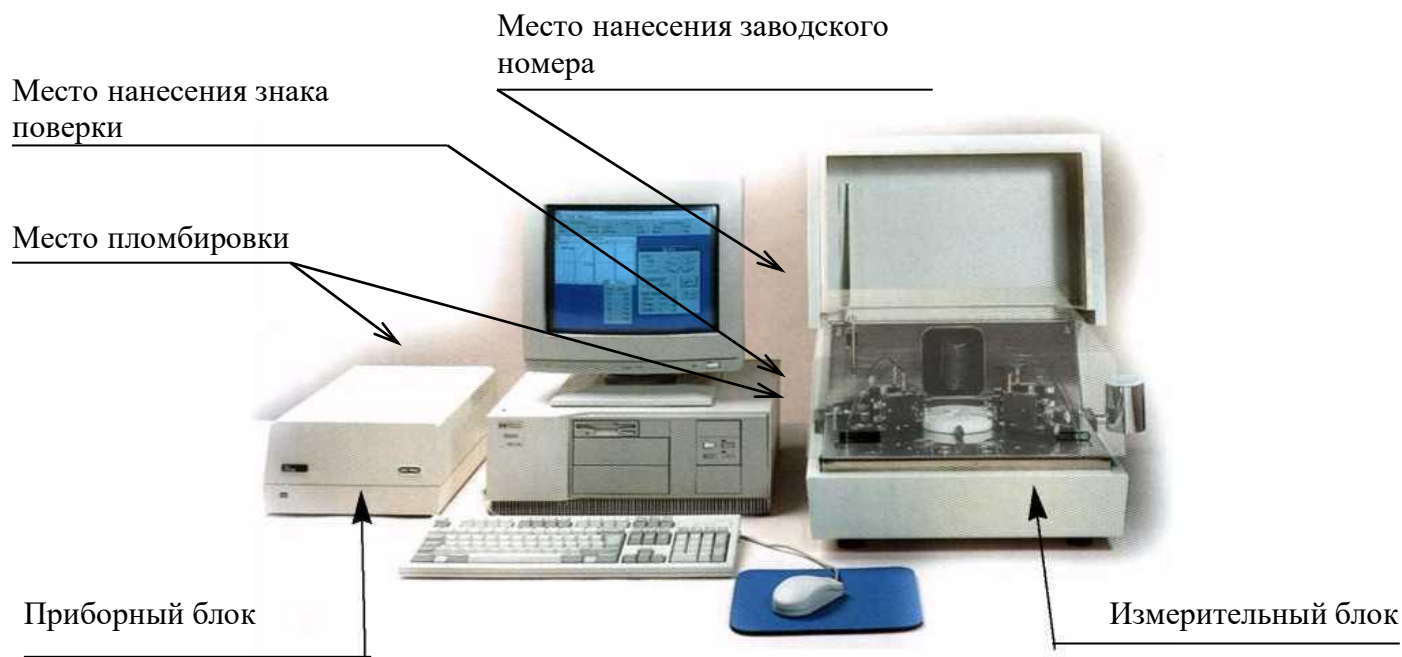
Рисунок 1 - Общий вид установки, схема пломбировки от несанкционированного доступа и обозначение места нанесения знака поверки
