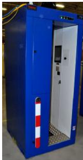
Рис. 1. Фотография общего вида монитора контроля поверхностного загрязнения персонала IPM9X
