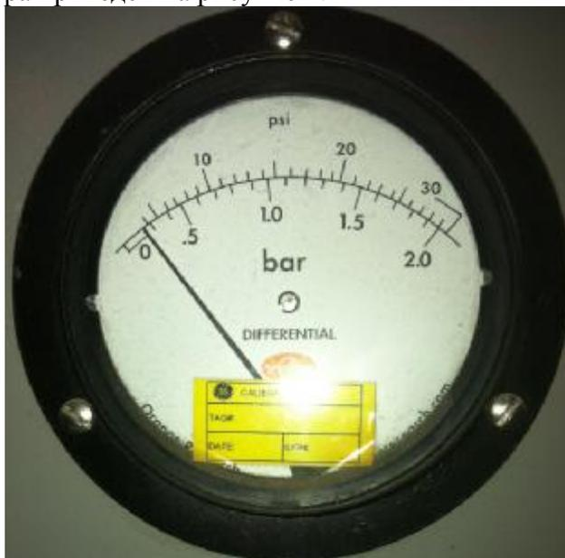
Рисунок 1. Манометр дифференциальный показывающий 1502DG.
