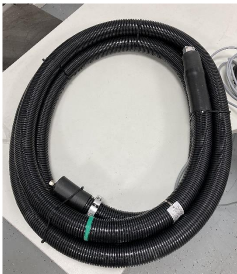
Рисунок 3 – Общий вид обогреваемой линии модели ETL GSL
