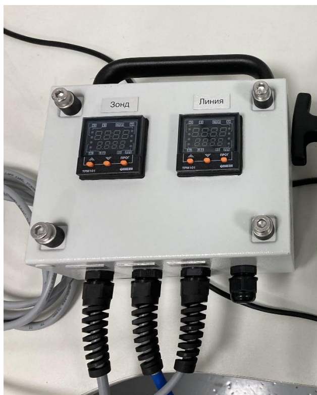
Рисунок 4 Общий вид блока терморегулирования для зонда и греющей линии уличного типа ETL.197.100.4700
