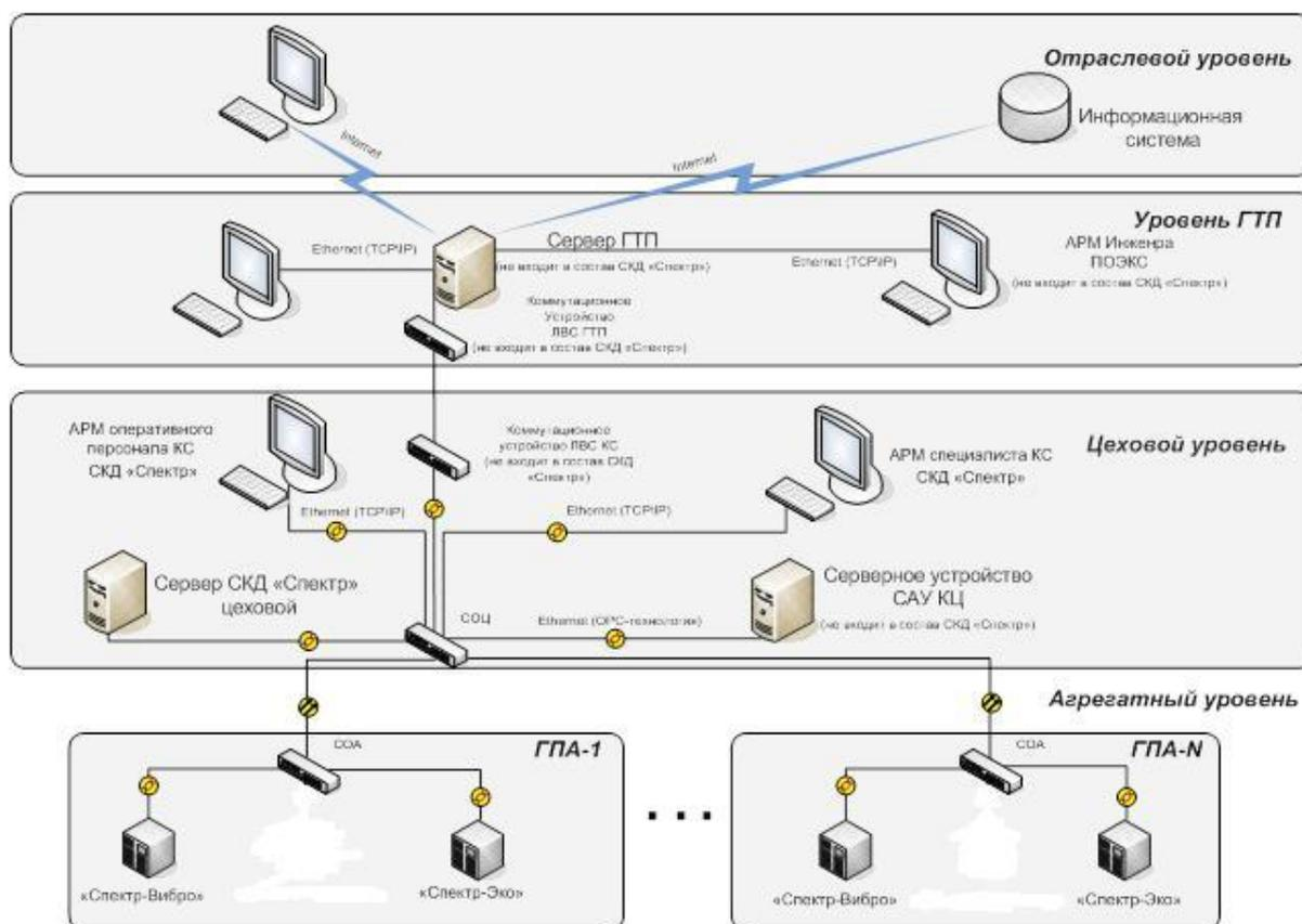
Рисунок 1 – Структурная схема систем комплексной диагностики «Спектр»
