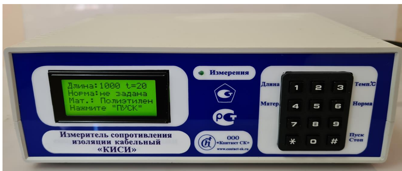
Рисунок 1 – Общий вид измерителей сопротивления изоляции кабельных «КИСИ». Вид спереди
