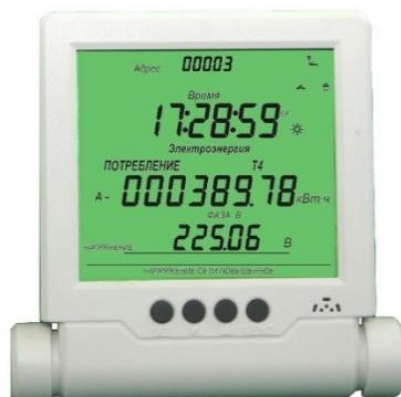
Рисунок 6 – Общий вид дистанционного индикаторного устройства
