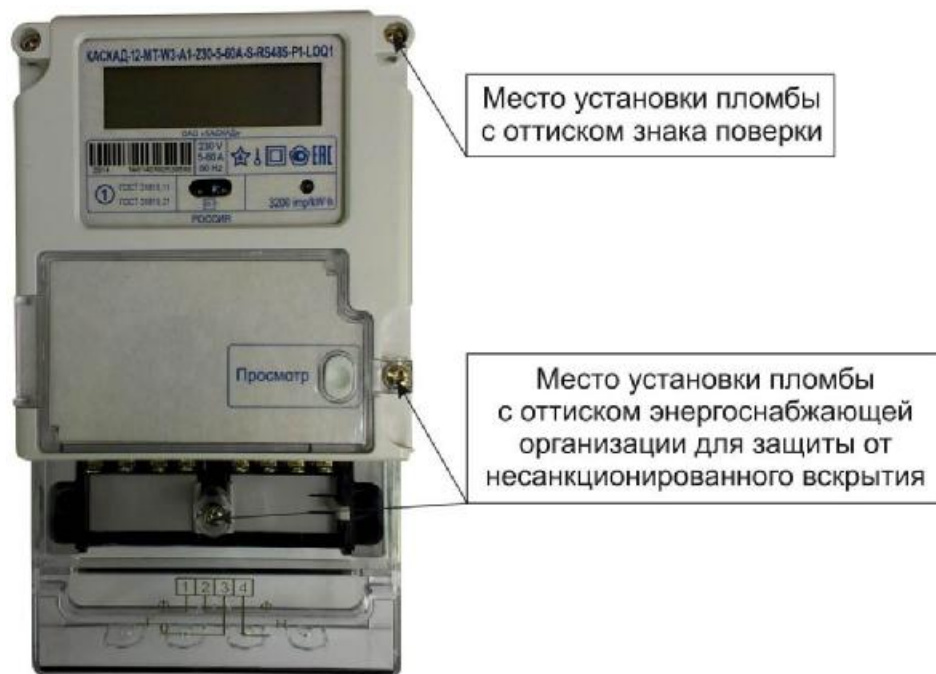
Рисунок 2 – Общий вид счетчика в корпусе типа W3
