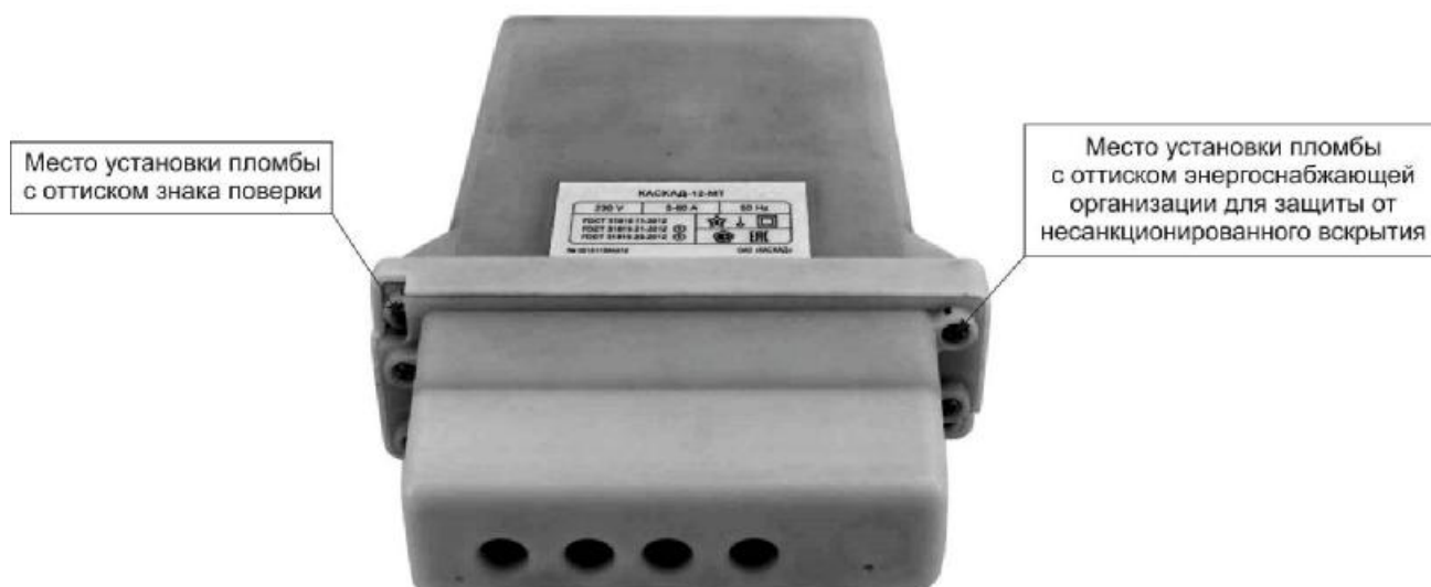
Рисунок 5 – Общий вид счетчика в корпусе типа SP1
