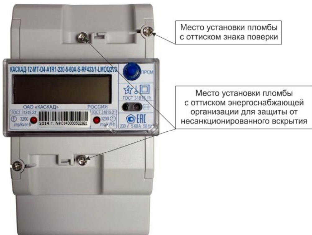
Рисунок 4 – Общий вид счетчика в корпусе типа D4
