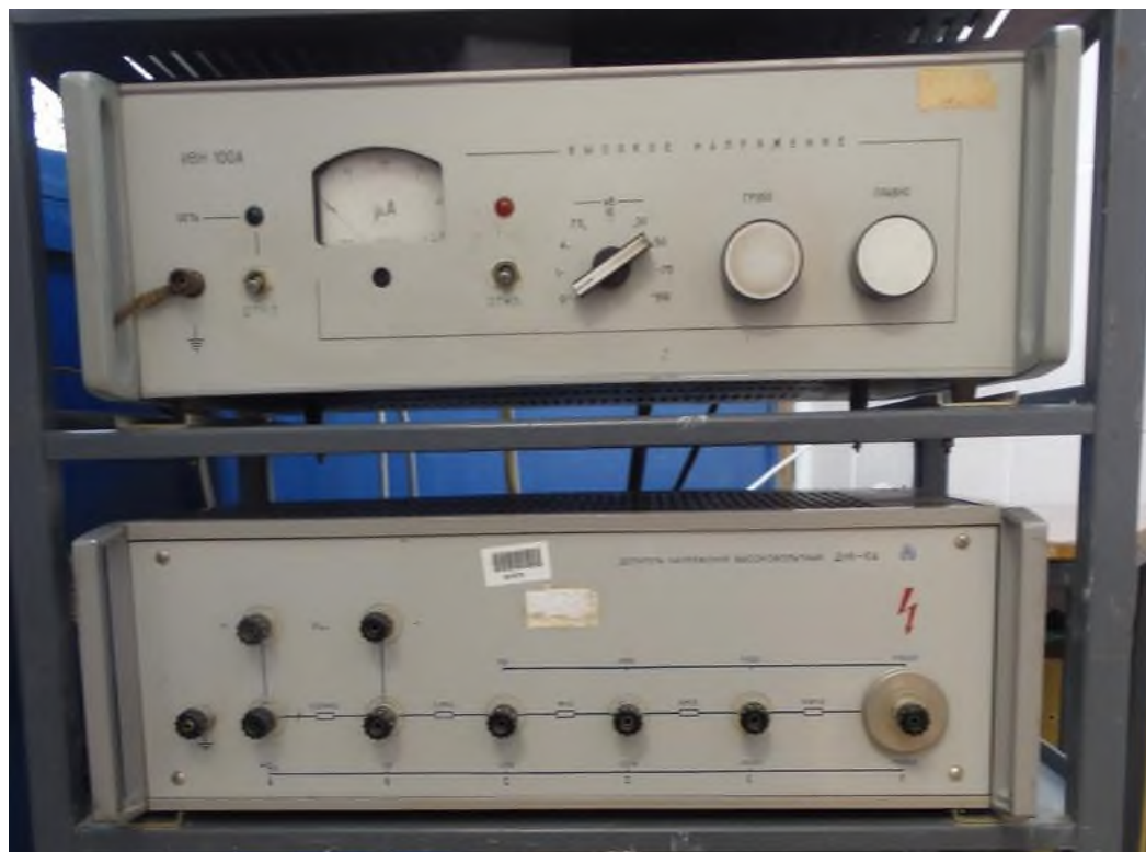
Рисунок 1 - Общий вид делителя ДНВ-10А и блока ИВН-100А
