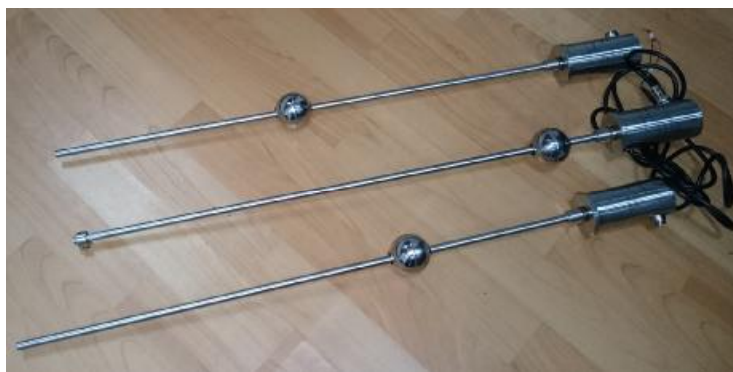
Рисунок 1 - Общий вид уровнемеров магнитострикционных КУСМ-НХ600F
