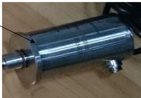
Рисунок 2 - Место пломбировки уровнемера
