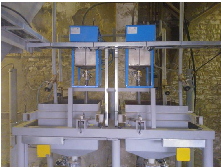
Комбинированные узлы взвешивания жидких материалов и воды
