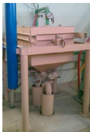
Узел взвешивания воды
