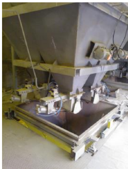
Узел взвешивания инертных материалов
