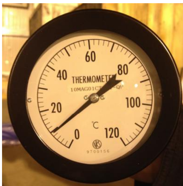
Рисунок 1 - Внешний вид термометра биметаллического ТВ14-120
