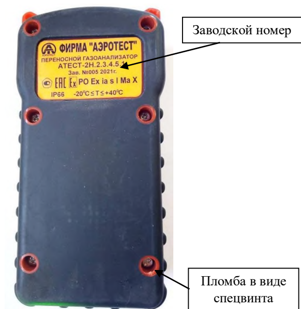
Рисунок 2 - Вид сзади и место пломбирования корпуса от несанкционированного доступа газоанализаторов
