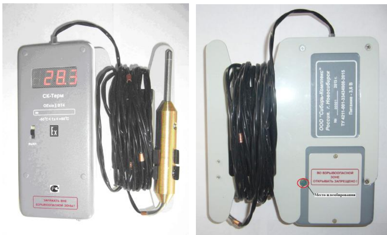
Рисунок 1 – Общий вид и схема пломбирования
