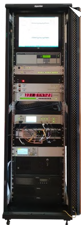
а) Аппаратура беззапросных измерений и сличений эталонов времени и частоты по сигналам ГНСС опорная
