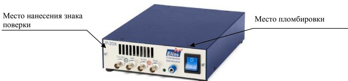
Рисунок 1 – Внешний вид потенциостата-гальваностата P-20X
