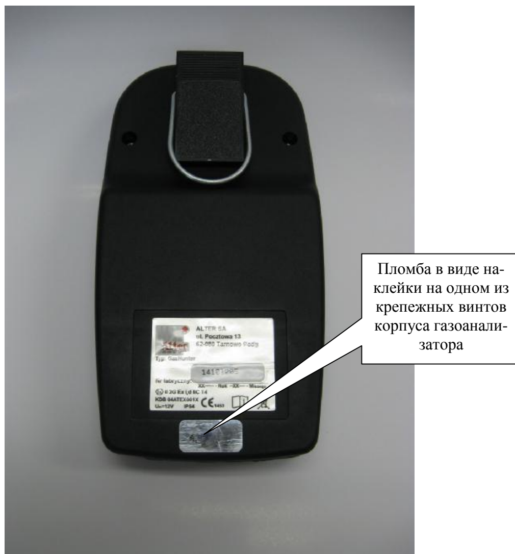
Рисунок 2 – Схема пломбировки корпуса газоанализатора для ограничения несанкционированного доступа
