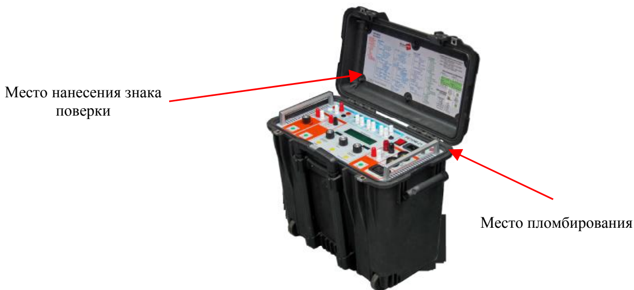
Рисунок 1 – Общий вид устройств, места пломбирования и нанесения знака поверки
