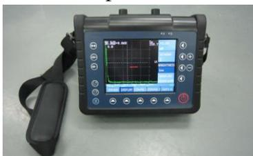
Рисунок 3 - Общий вид дефектоскопов ультразвуковых AlfaScan
