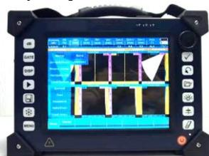
Рисунок 5 - Общий вид дефектоскопов ультразвуковых AlfaScan II
