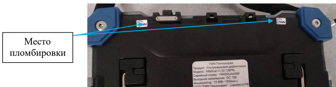
Рисунок 12 - Схема пломбировки от несанкционированного доступа
