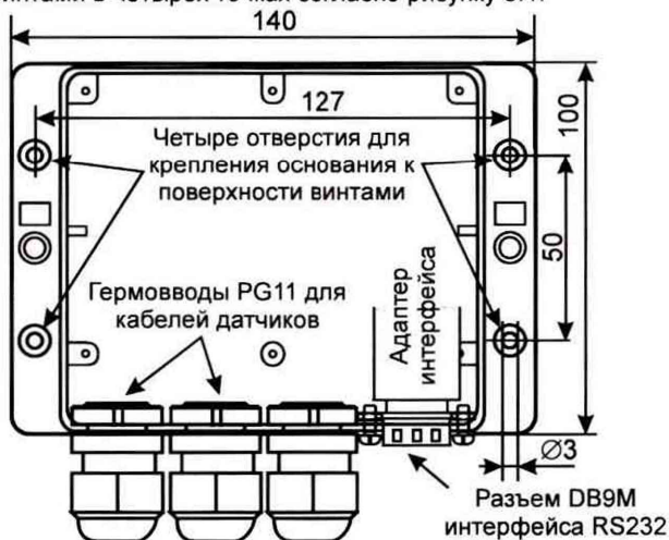
Рисунок 5.1 – Схема крепления вычислителя
