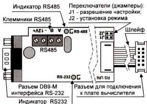
Рис. Г.1 – Внешний вид платы универсального адаптера интерфейсов
