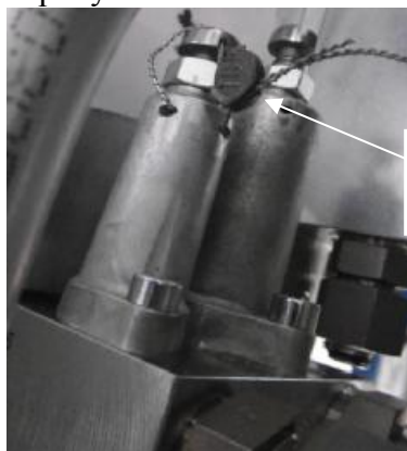
Рисунок 8 – Место установки металлической пломбы
