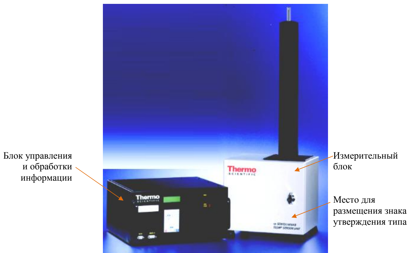
Рисунок 1 – Внешний вид анализатора пыли ТЕОМ 1400АВ и обозначение места для размещения знака утверждения типа
