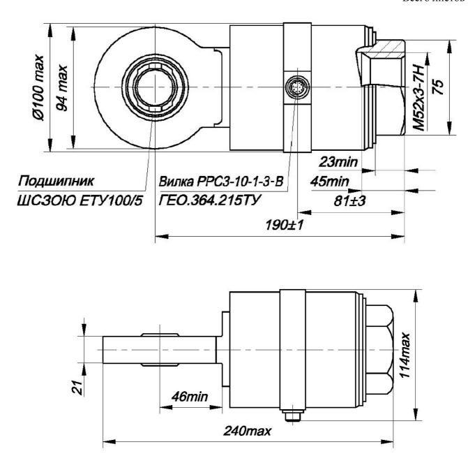
Рисунок 2 – Габаритно-установочные размеры ПСП Вт 114
