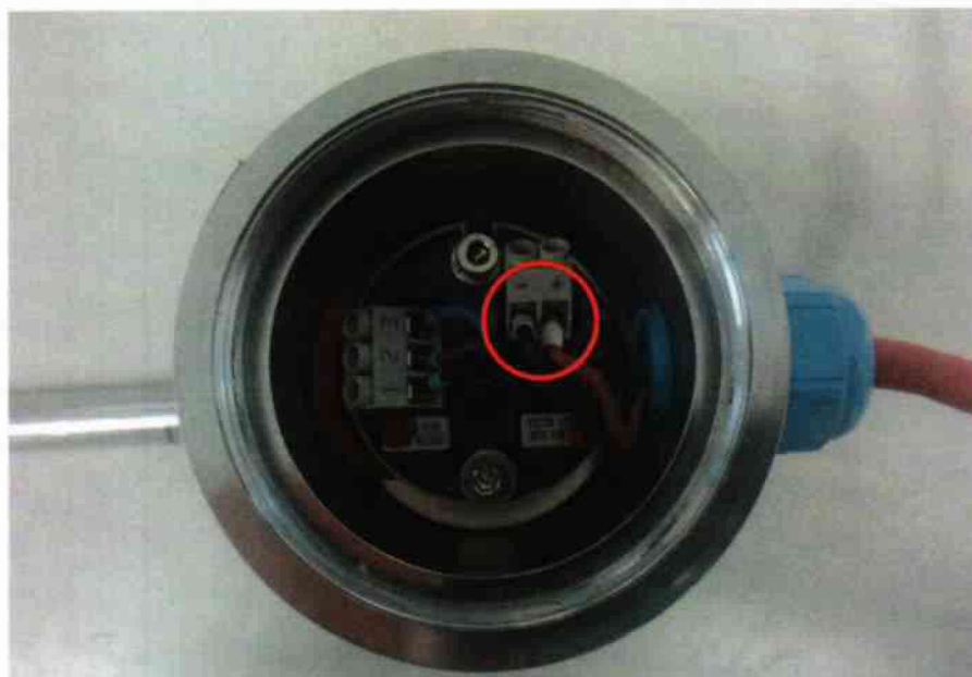
Рисунок 1. Схема подключения калибратора к токовому выходу преобразователя.
