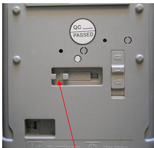
Рисунок 2 – Место пломбировки весов
