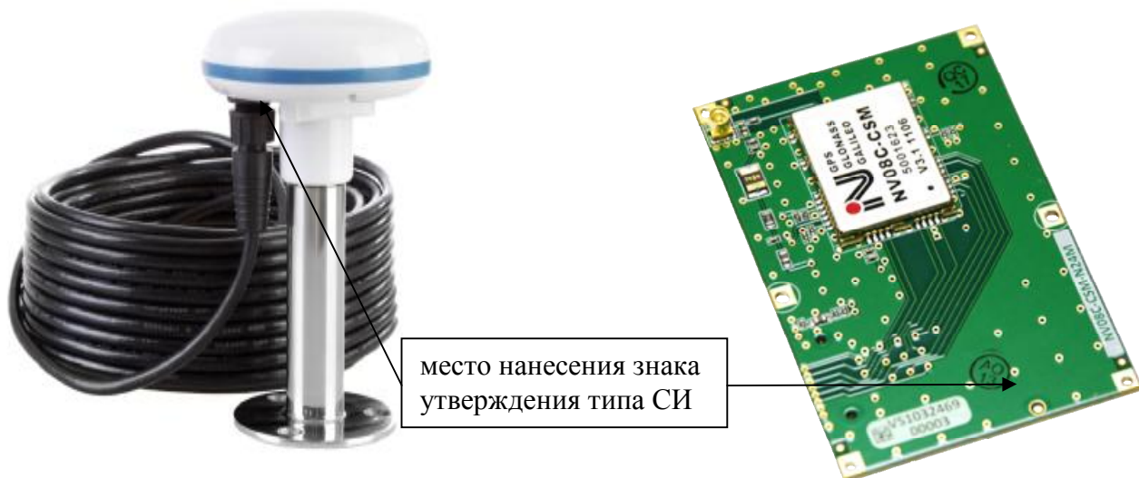
Рисунок 3 - ПВС NVS-GNSS-MTA (с монтажной стойкой и кабелем интерфейсным)
