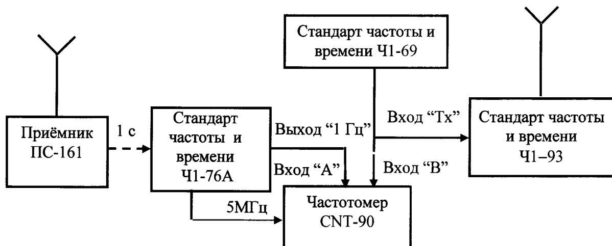
Рисунок 10 – Определение погрешности измерения расхождения шкалы времени контролируемого прибора и шкалы времени UTC(SU) встроенным ИВИ в режиме непрерывной синхронизации по сигналам ГНСС ГЛОНАСС и GPS и погрешности измерения расхождения шкалы времени контролируемого прибора и шкалы времени UTC(SU) встроенным ИВИ после синхронизации ИВИ шкалой времени UTC(SU) на интервале наблюдения 10 минут.
