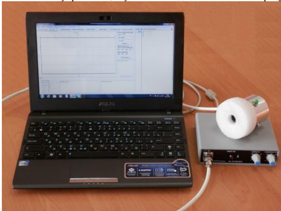
Рисунок 1 - Общий вид прибора акустического контроля труб ПАКТ-04
