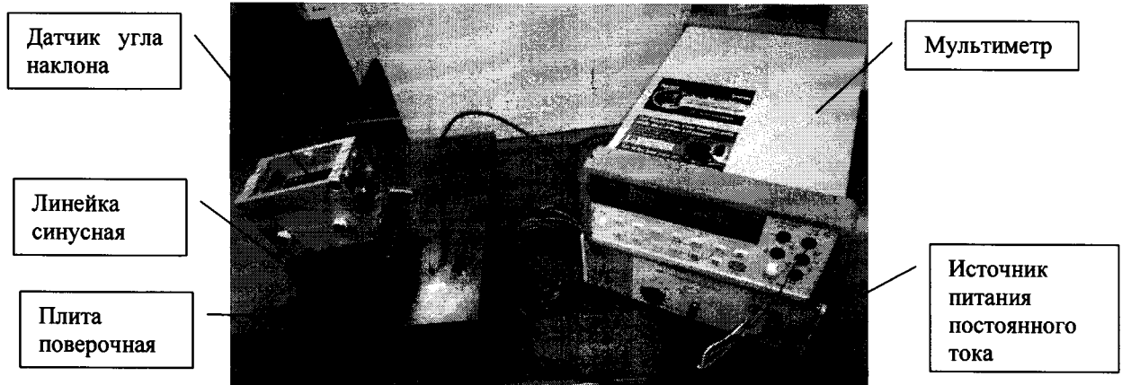
Рис. 2. Блок – схема поверки датчиков угла наклона модификаций T410-X005, T410-X030, T410-X100, T420-X005- Y005, T420-X030-Y030, T420-X100-y100, T500-005, T500-030, T500-100
