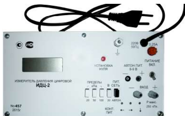
Рисунок 1 – Общий вид измерителей давления цифровых ИДЦ-2
