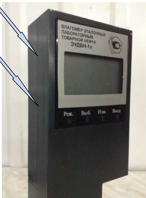
Рисунок 2 - Место пломбирования влагомеров эталонных лабораторных товарной нефти ЭУДВН-1л
